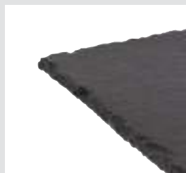
gebrochene Kanten broken edges
